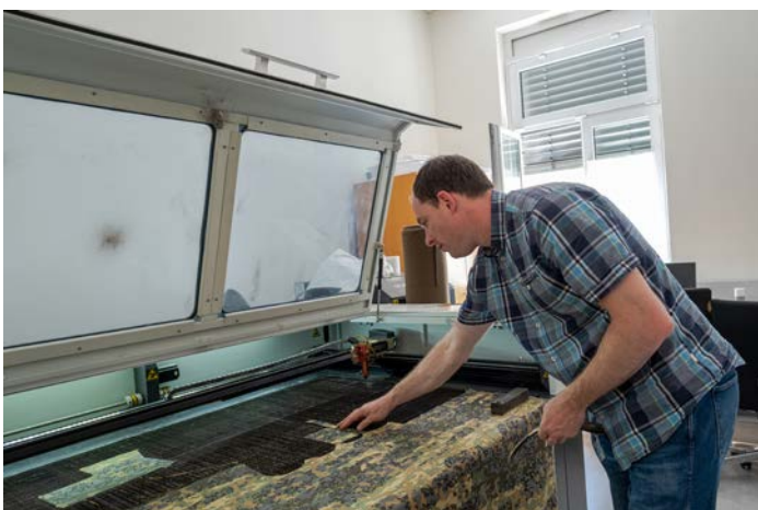
Der Laser Cutter macht die Schneidarbeit. Sauber und präzise. Hier wurde auch der Stoff für die 140 000 Mund- Nasenschutzmasken geschnitten, die während der Corona-Pandemie produziert wurden.
