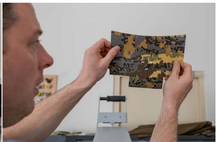
Egal ob der Laser Cutter 1 Stück oder 1 000 Stück schneidet, die Qualität ist immer gleich. Die geschnittenen Öffnungen fransen nicht aus, der Laser setzt auch gleich Markierungspunkte für die Schneiderei.
