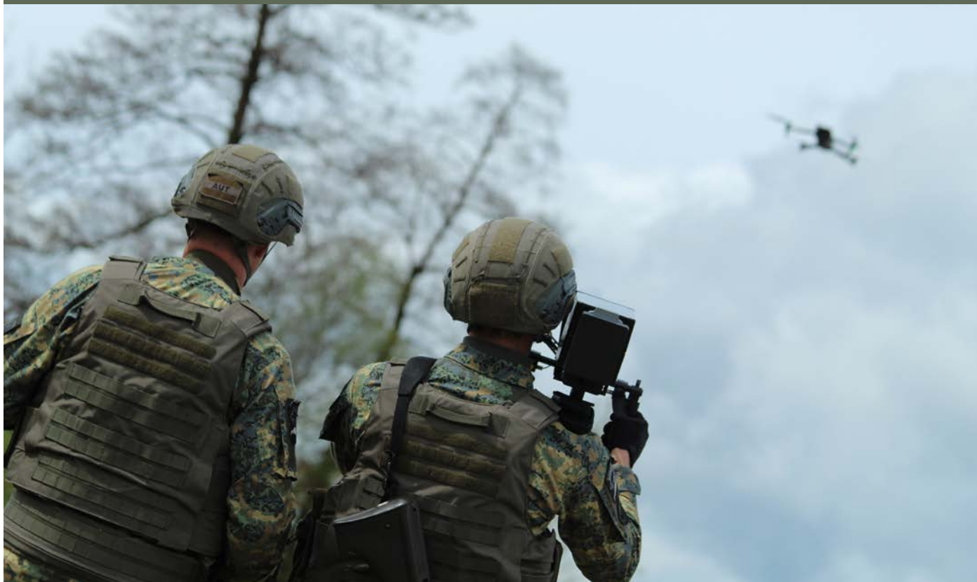
Das elektronische Drohnenabwehrsystem des Jägerbataillons 8 unterbricht die Verbindung der Drohne zum Controller und zwingt die Drohne zum Landen. (Foto: Bundesheer/Mario Rettenbacher)
