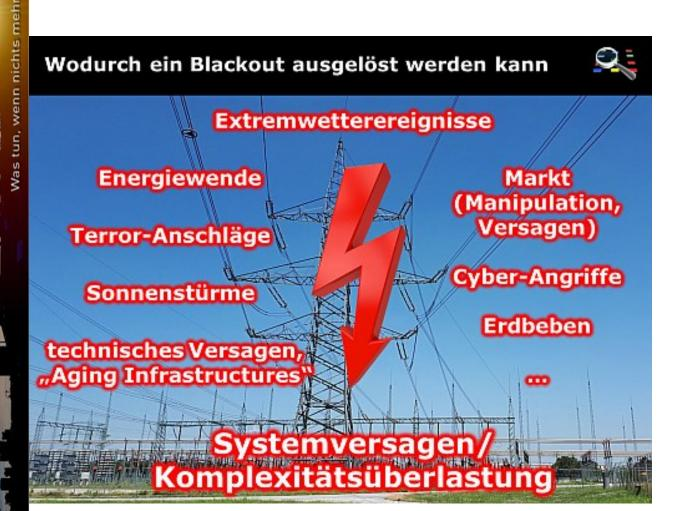
Spannung und Frequenz müssen in diesem physikalischen Stromsystem immer gleich hoch sein, sonst kommt es zu Ausfällen. Im europäischen System wird eine Netzfrequenz von 50 Hertz verwendet. Ein Stromversorgungssystem auf Basis von Wechselstrom funktioniert nur, wenn eine permanente Balance zwischen Erzeugung und Verbrauch sichergestellt werden kann. Ansonsten kollabiert das System.
