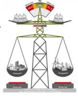
Sinkt oder steigt die Frequenz im Netz zu rasch, können wichtige Generatoren Schaden nehmen.
